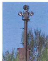
土石流などを監視しているカメラ
