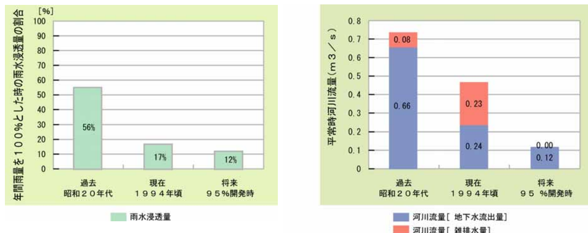
図 3-2-2. シミュレーションモデルによる予測結果（矢上川流域・下水処理水が流入しない地点） （左：年間雨水浸透量の減少 右：平常時河川流量の減少）
