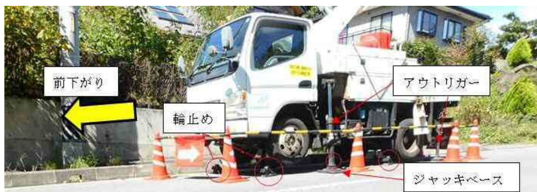
図４－３ 高所作業車駐車状況
