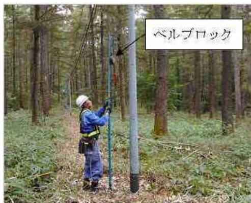
図 3-4 ベルブロック使用状況①
