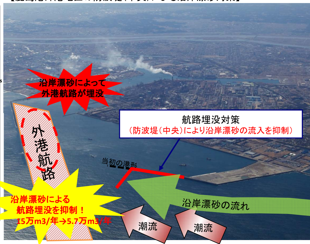
【鹿島港外港地区の防波堤(中央)による沿岸漂砂対策】
