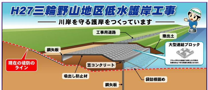
はじめに鋼矢板・笠コンクリート、盛土・吸出し防止材、大型連結ブロック、袋詰根固め・撤出土、おわりに工事用道路の順に施工。
