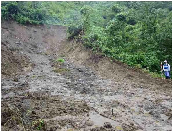
道路脇の土砂崩れ幅を計測
