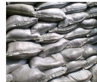
スーパーUV土のうの例 (紫外線劣化防止剤の添加により耐候性を改善した土のう)
