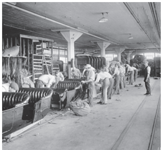
③ 流れ作業方式 ベルトコンベアによる組み立て方式により、1台の生産時間は12時間半から半減。さらなる改善で短縮されていきました。[写真：Ford Motor Company]
