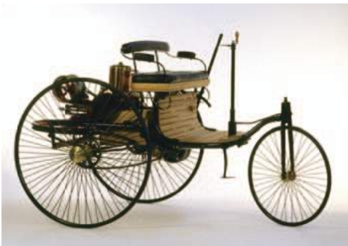
① ガソリンエンジンで走った最初の自動車 最高時速は20km前後だったとされます。[写真：メルセデス・ベンツ日本]
