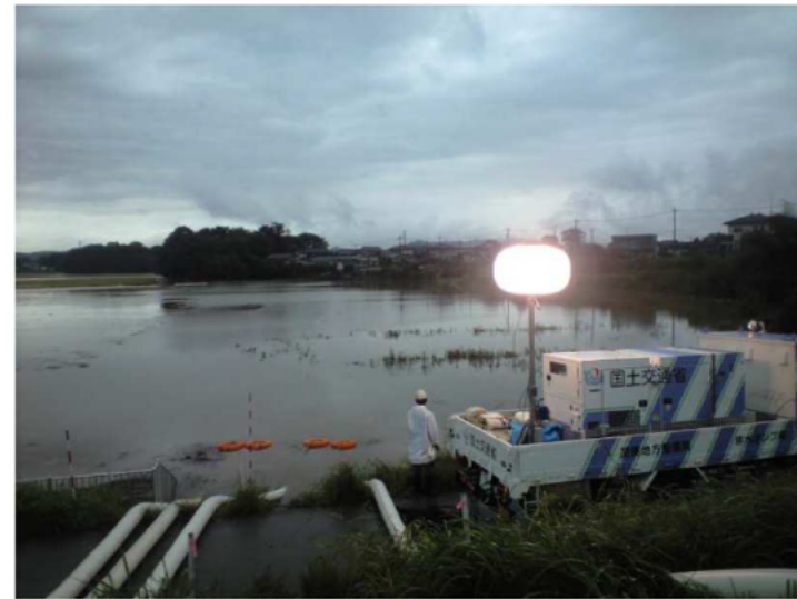
排水ポンプ車の災害活動状況（平成23年9月栃木県栃木市）
