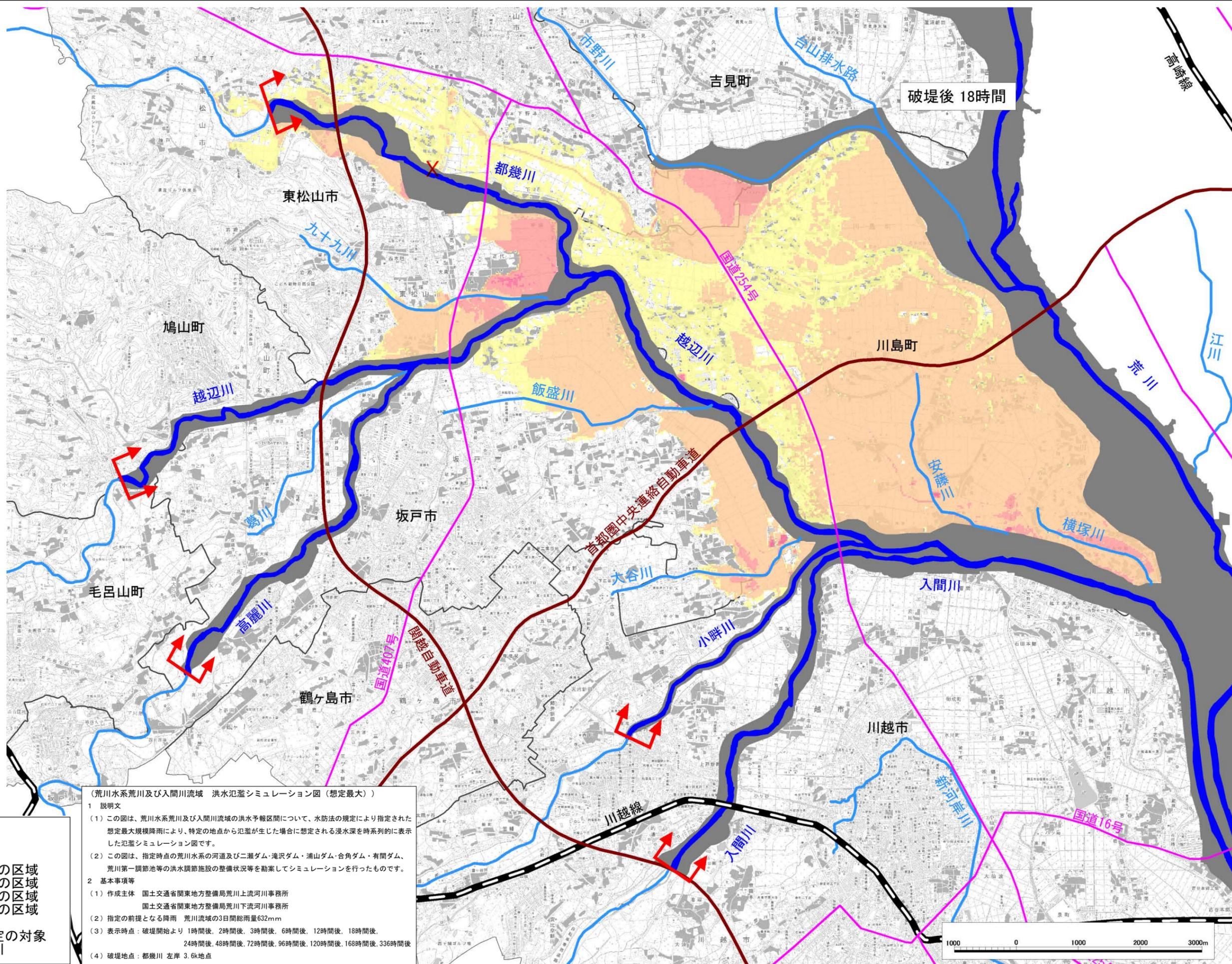
(荒川水系荒川及び入間川流域 洪水氾濫シミュレーション図(想定最大))
