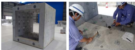
写真-4 国総研模擬アンカー供試体 打音状況
