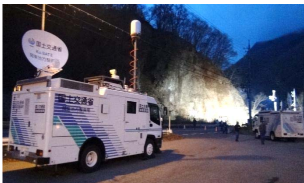
衛星通信車による被害映像の送信 (長野県北部地震)
