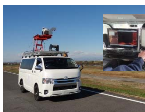
MMSIによる計測状況
