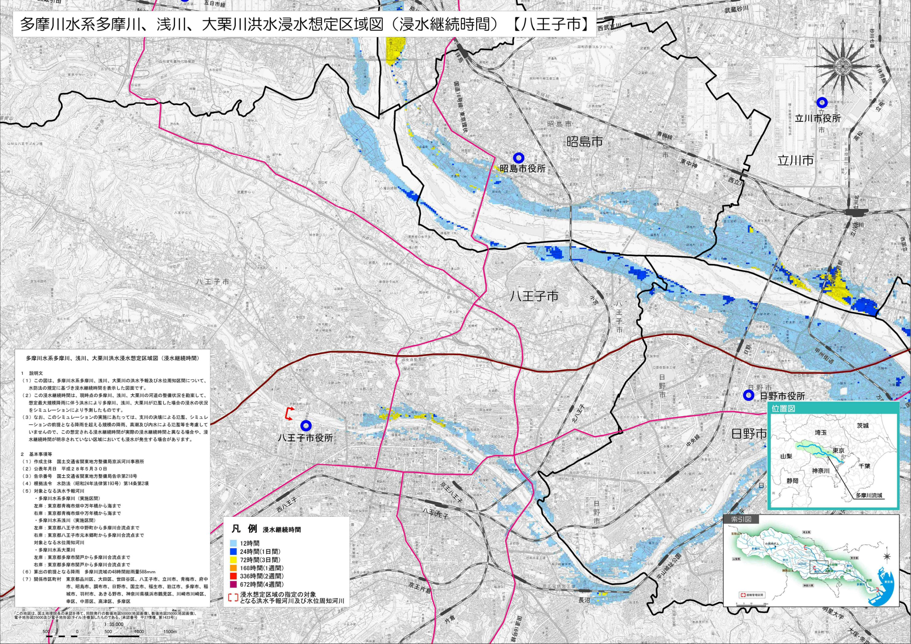
**多摩川水系多摩川、浅川、大栗川洪水浸水想定区域図（浸水継続時間）**
