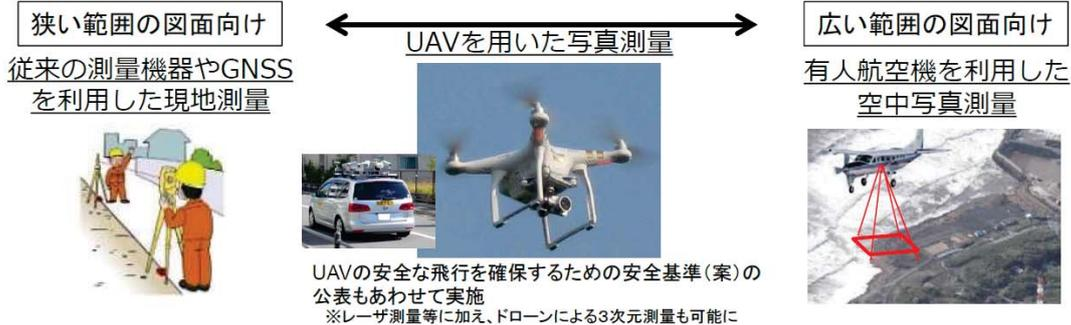
②公共測量の成果にUAV写真による3次元点群データを追加
