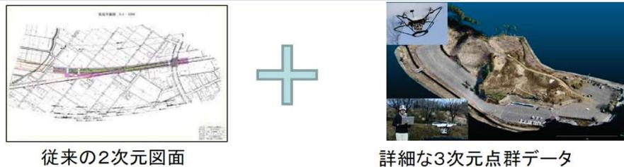
導入効果: 小回りがきくUAVや3次元化の自動ソフトの導入により、短時間で効率的に3次元点群データが作成可能
