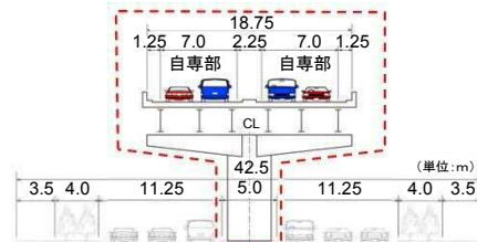
■標準横断面図(新大宮バイパス・自専道部)
