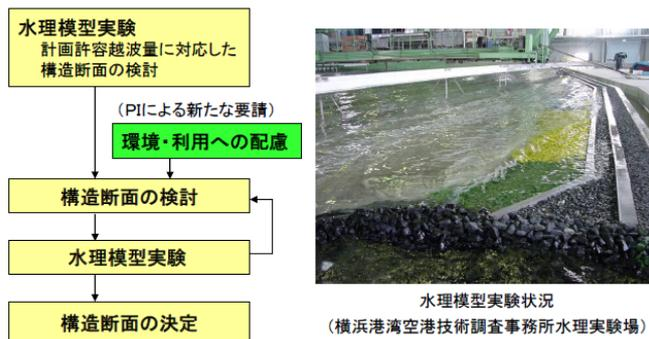
図7 構造断面決定のための設計条件・水理模型実験の手順
