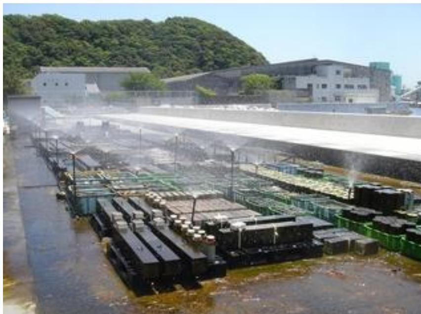
厳しい自然環境特性をいかし、海洋構造物の構造部材として用いることのできる新素材(繊維系複合材、超耐食性金属等)の技術評価試験を実施することで新素材を開発し、海洋構造物等へ適用することにより港湾施設の維持管理費の低減が期待されます。
