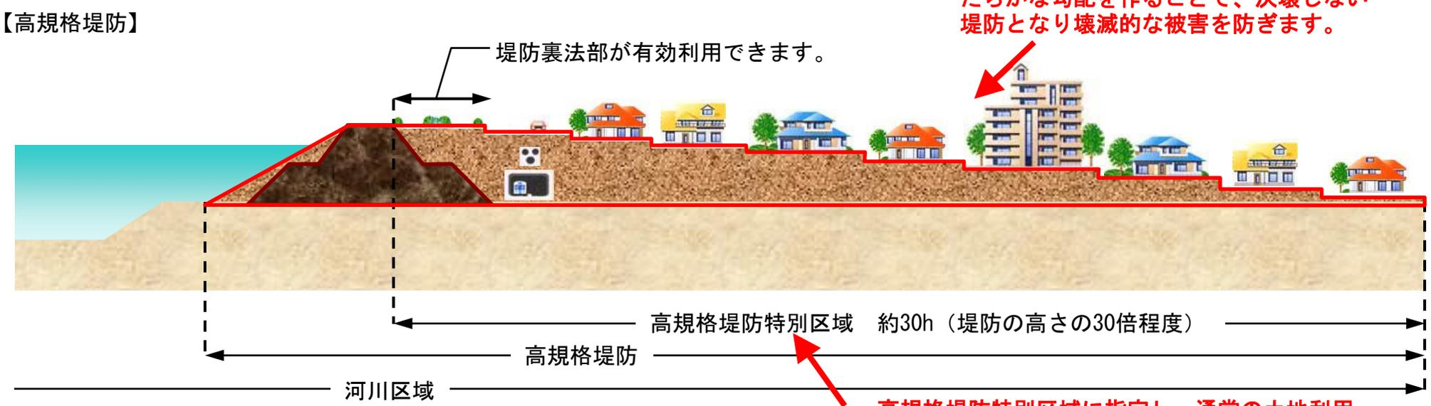
計画規模を超える洪水が来た場合でもなだらかな勾配を作ることで、決壊しない堤防となり壊滅的な被害を防ぎます。
