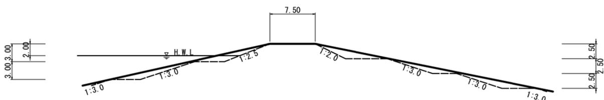
※各河川(区間)における、標準的な堤防の断面形状(破線)を示す。
