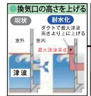
下水道施設の耐震強化・耐水化
