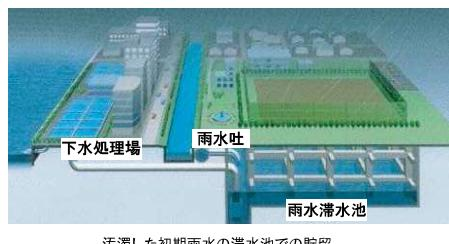
汚濁した初期雨水の滞留池での貯留
