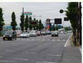
写真A 【前橋市街方面への右折需要が多く、捌け残りが発生】
