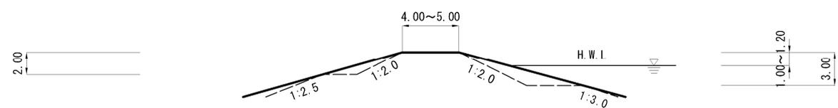
※各河川（区間）における、標準的な堤防の断面形状（破線）を示す。
