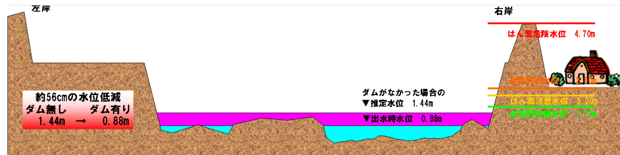
宮ヶ瀬ダムの洪水調節効果(才戸橋)
