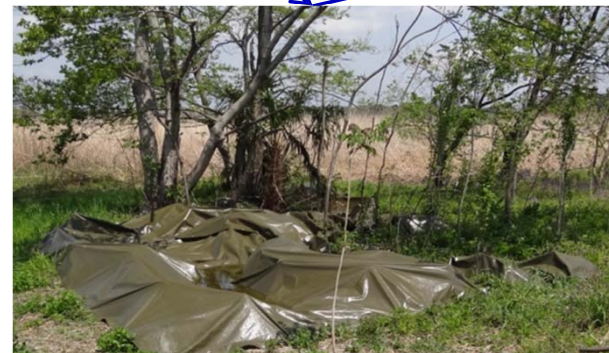
シンジュの大木を伐採して地表にシートをか ぶせる試験をしました。(H25.4.26撮影)
