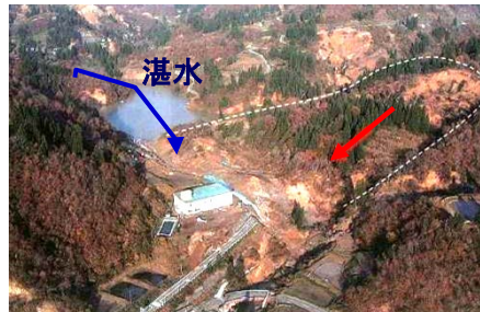
【河道の閉塞及び上流湛水の事例】
