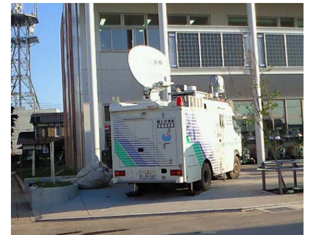
衛星通信車での通信回線の確保
