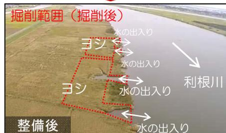
河川敷の水際を掘削しヨシを形成することで利根川の水が出入りし、水際部の水質浄化に寄与しています。
