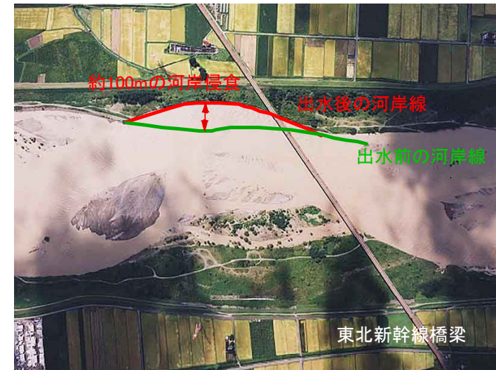
平成13年9月洪水 河岸侵食状況 東北新幹線橋梁付近
