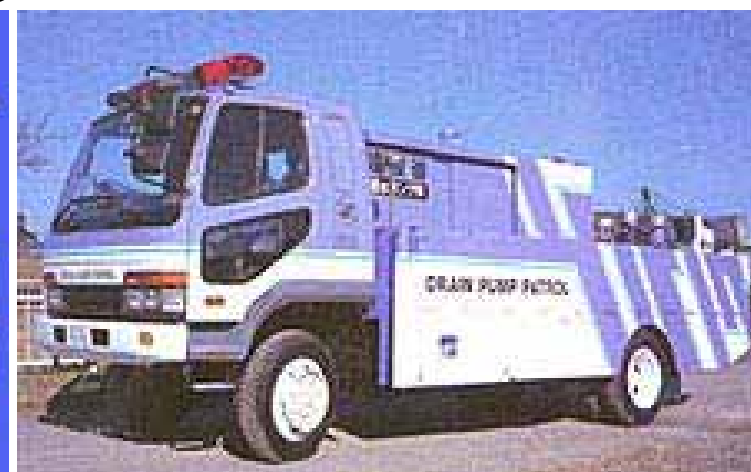
被害軽減対策 （排水ポンプ車）
