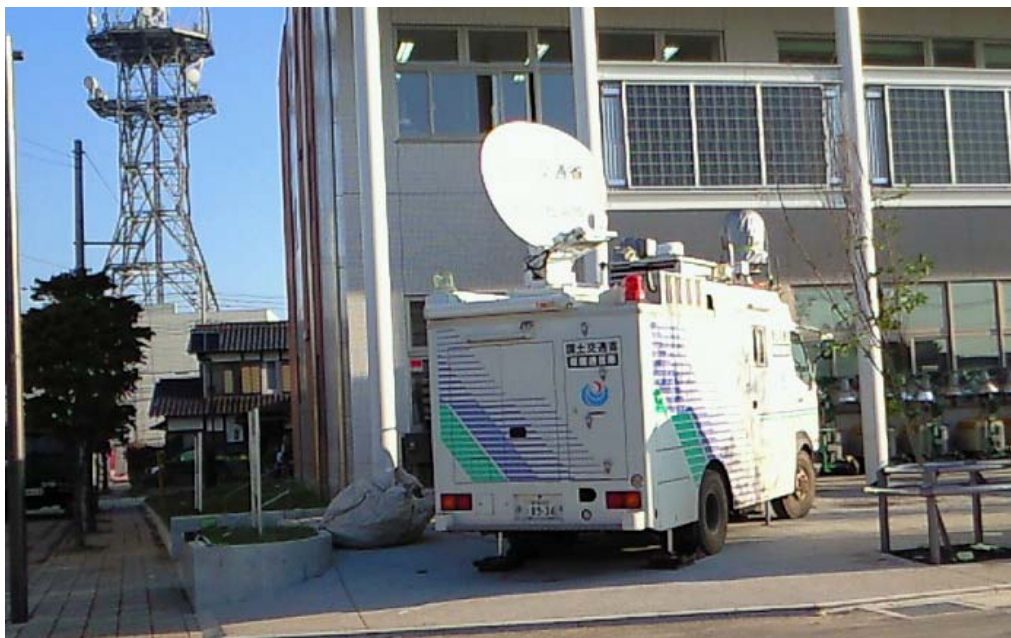
常総市に設置した国土交通省の衛星通信車
