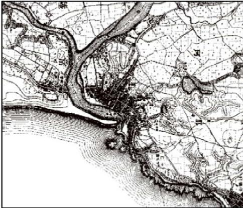
河口部の砂州を掘削(明治27年(1894))して河口を付け替え、湊を建設した。(大正4年(1915)および大正6年(1917)5万分の1地形図)
