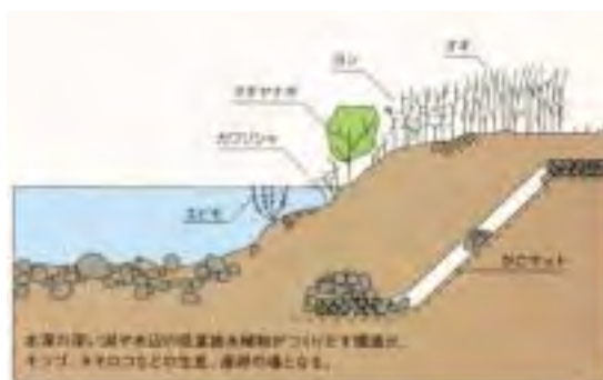
ワンド断面図（多摩川的环境と川づくり、京浜河川事務所）
