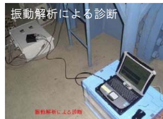
河川排水ポンプ施設の振動解析
