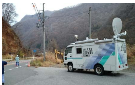
衛星通信車配置状況
