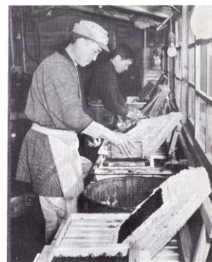
▲のり抄き（よし置の上に「わく」をのせ杵（ます）で抄く）
