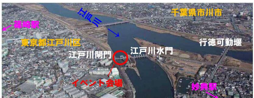
(※)閘門とは、水位の異なる川や運河の間で船を上下させて、航行させるための施設です。固定された閘室(前後を仕切った空間)内の水位を変えることで、船を上下させるのが特徴です。なお、この仕組みはパナマ運河でも採用されています。
