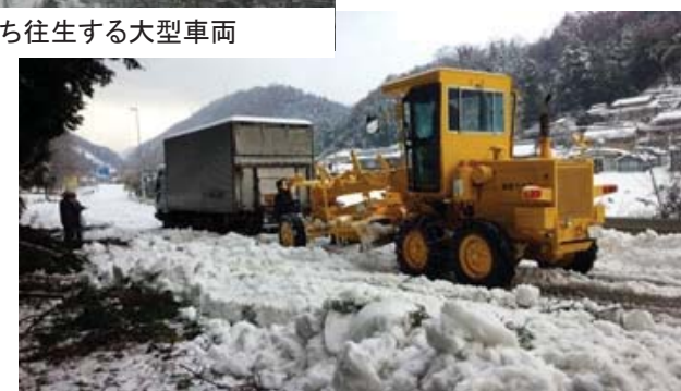
除雪車により車両を牽引
