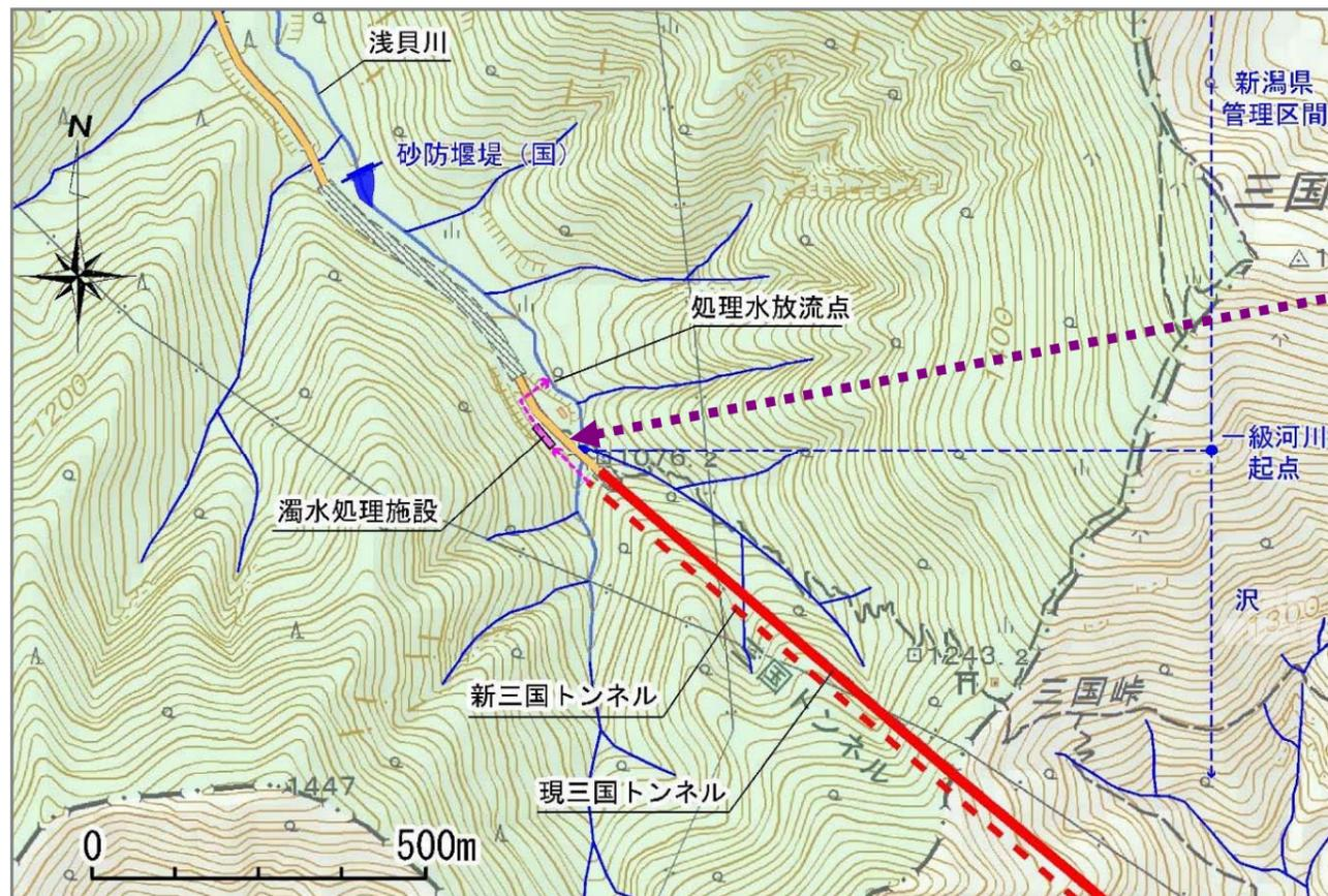
図 5.1.2-2 濁水処理設備配置概念図
