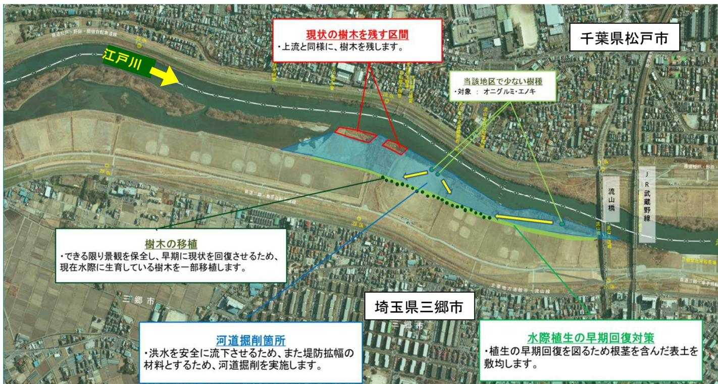
江戸川河川事務所では、台風等により発生する洪水を安全に流下させるための工事（河川敷を掘削し川幅を広げる工事）を実施します。
