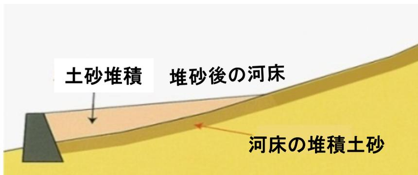
土砂堆積により、山腹の崩壊、河床からの土砂の流出を抑制します。
