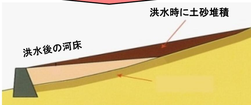
堆砂後も河道の勾配が緩くなり、洪水時土砂が一気に流下することを抑制します。
