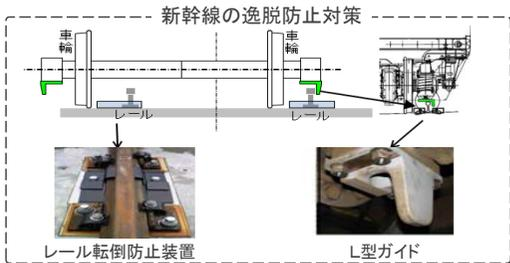
仮に脱線しても、車両装着のL型ガイドが転倒防止装置で補強されたレールに掛かり、線路から大きく逸脱することを防止する。
