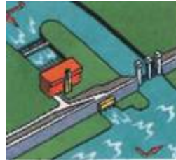
②本川が増水した時は、水門を閉じて支川にたまった水を排水機場のポンプで本川に排水します。
