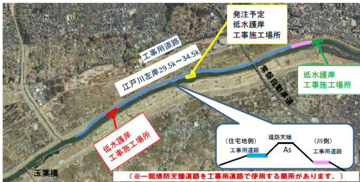
測量・調査は、7月下旬から。工事用道路施工、樹木伐採は8月中旬頃～10月中旬頃。低水護岸工事は10月中旬頃から着工させて頂く予定です。
