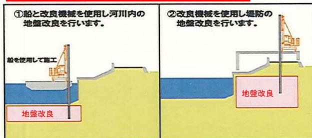
鶴見川下流部では昨年度に続き、大きな地震時に堤防下が液状化し、堤防の高さが一定以下になってしまうカ所の堤防耐震工事を行います。
