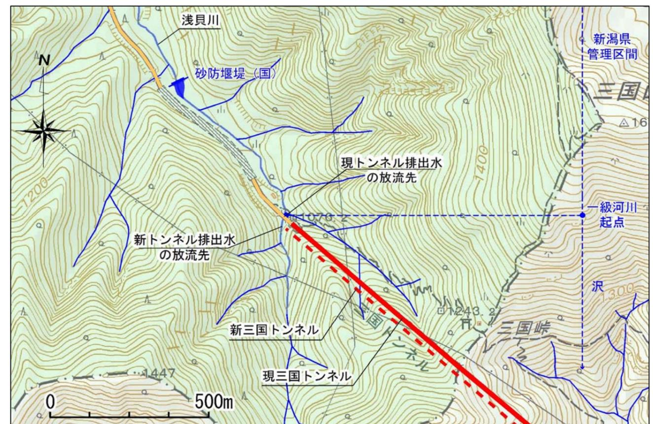
図 3. 3. 2-1 トンネル完成後の排水水の放流先
