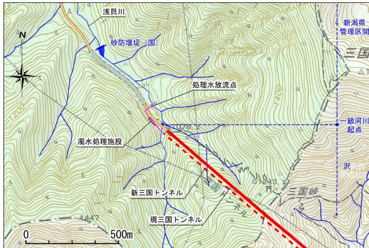
図 3. 3. 1-1 トンネル施工中の排水水（濁水）の処理水放流先
