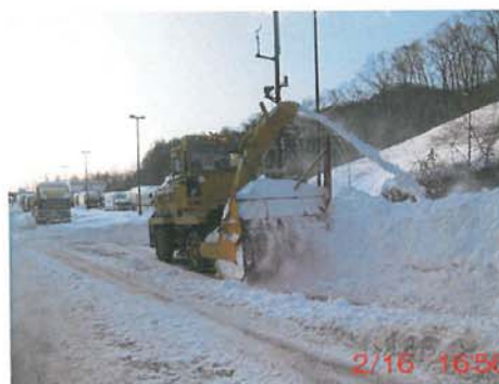
長野国道・北陸地整からの応援車両(ロータリー除雪車・除雪グレーダ)による除雪作業状況
