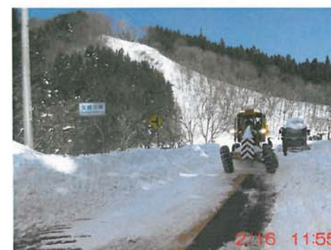
長野国道・北陸地整からの応援車両(ロータリー除雪車・除雪グレーダ)による除雪作業状況
