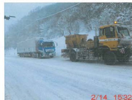
除雪トラックによるスタック車両のけん引状況
