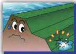
漏水とは、洪水の水が堤防や堤防の下の地面を通して住宅や農地のある側に漏れ出てくることです。
