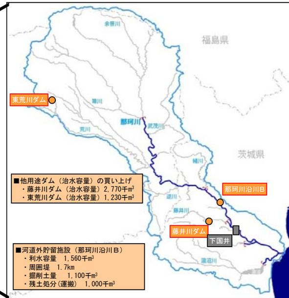
図 4.4-50 流水の正常な機能の維持対策案の概要 ケース 2 他用途ダム容量（治水容量）買い上げによる流水の正常な機能の維持対策案
