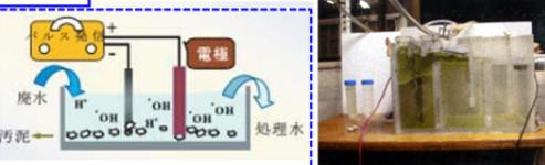
出典：電気化学的高速廃水処理装置の開発
