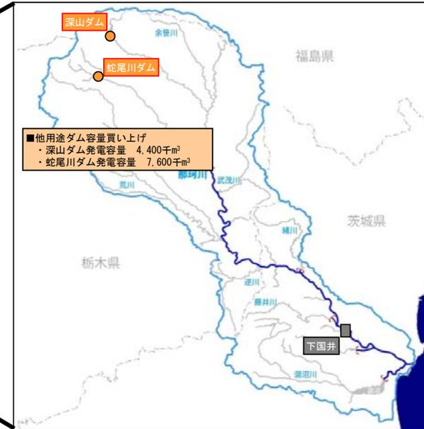
図 4.4-51 流水の正常な機能の維持対策案の概要 ケース3 他用途ダム容量（発電容量）買い上げによる流水の正常な機能の維持対策案
