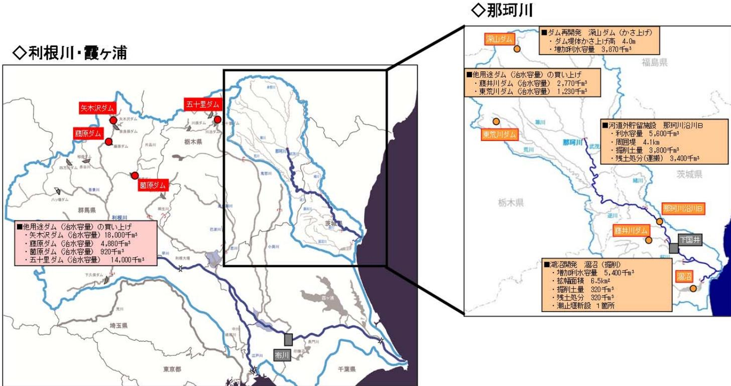
図 4.3-63 新規利水対策案の概要 ケース2 他用途ダム容量（治水容量）買い上げによる新規利水対策案
