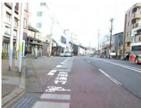
写真Ⅱ- 10 バス専用通行帯を活用し路面表示を設置した事例
