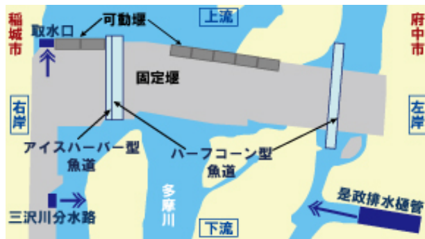
大丸用水堰 取水口と魚道の位置
