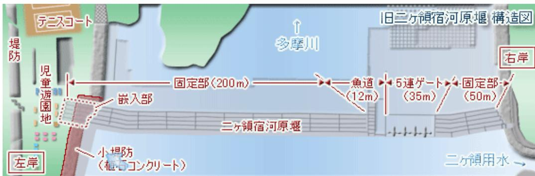
小堤防は、古くからあった堤防を二ヶ領宿河原堰改築の際に補強したもので、厚さ15cmの植石コンクリート造りで全体的に弱く、流水を固定部に導流するために水際に設置されていた事から、真っ先に崩壊したと考えられます。
