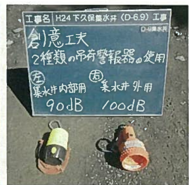
（写真・12）吊り荷警報器の比較使用
